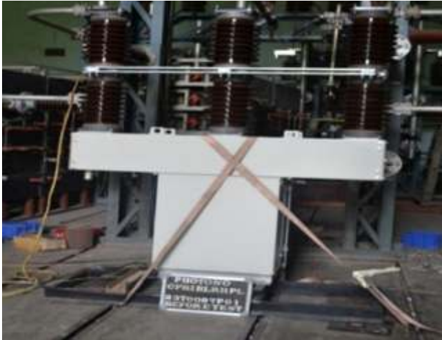
एकल चरण विधि द्वारा 36 केवी, 31.5 केए तीन चरण परिपथ वियोजक पर लघु परिपथ परीक्षण कार्य
