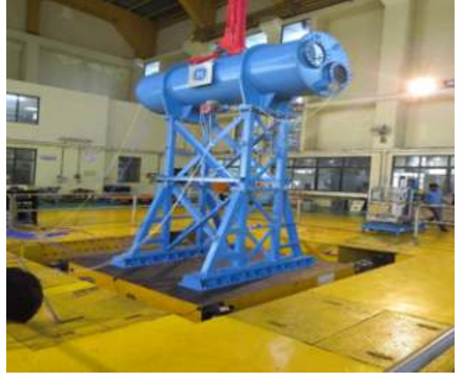
अपतटीय अनुप्रयोग के लिए संरक्षक असेंबली पर भूकंपीय परीक्षण और कंपन परीक्षण
