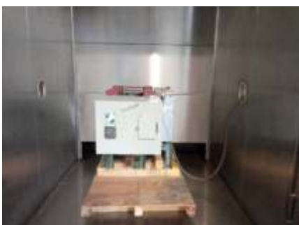
जीआईएस स्विचगियर नियंत्रण क्यूबिकल्स पर शुष्क ताप और नम ताप परीक्षण के लिए पर्यावरणीय सिमुलेशन परीक्षण
