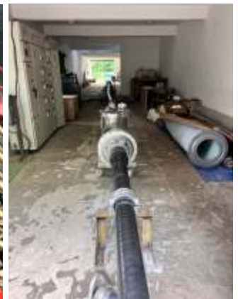
पूर्व-योग्यता परीक्षण व्यवस्था - 220 केवी केबल प्रणाली के लिए जीआईएस सहायक उपकरण के साथ केबलों का टर्मिनेशन और बिछाना
