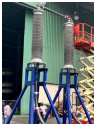
पूर्व-योग्यता परीक्षण व्यवस्था - 220 केवी केबल प्रणाली के लिए जीआईएस सहायक उपकरण के साथ केबलों का टर्मिनेशन और बिछाना
