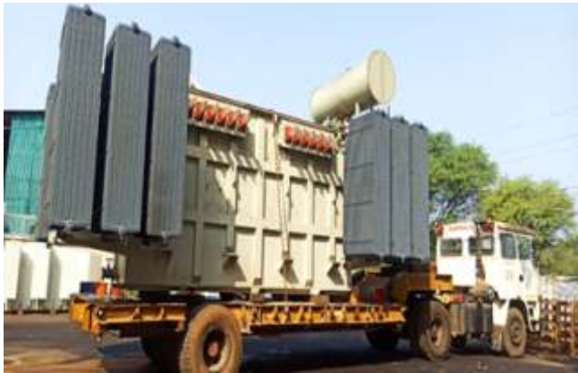
18 एमवीए, 33/0.69-0.69-0.69-0.69kV, पांच वाइंडिंग एल्यूमिनियम वाउंड, इन्वर्टर ड्यूटी ट्रांसफार्मर
