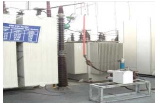
200केवीएआर 7.96केवी, आंतरिक एचवी संधारित्र पर अधिक वोल्टता परीक्षण की व्यवस्था
