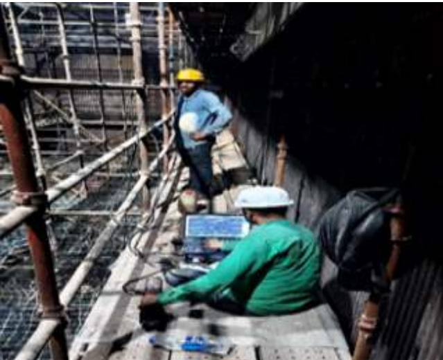
मेसर्स एनटीपीसी लिमिटेड, कोरबा सुपर ताप शक्ति केंद्र, कोरबा के लिए यूनिट क्रमांक 4, 500 मेगावाट के बॉयलर वाटर वॉल ट्यूबों का संक्षारण मानचित्रण।
